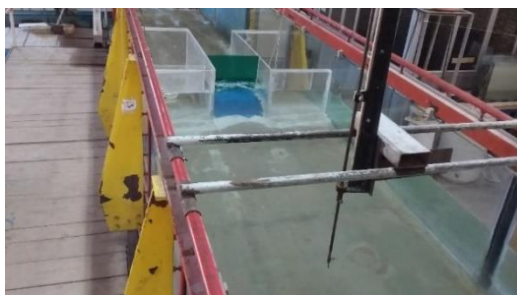
شکل ۳ - داده‌برداری از مدل در حین آبیگری و قرائت اشل
