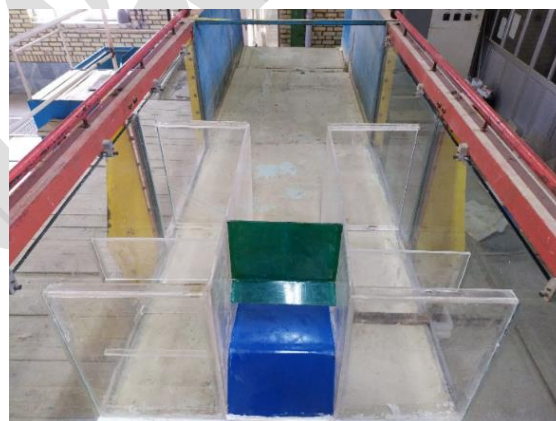
شکل ۵ - مدل آزمایشگاهی دریچه نیروپیک تیپ X1
