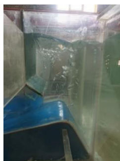
شکل ۴ - نمای جانبی مدل دریچه نیروپیک در حین آبیگری
