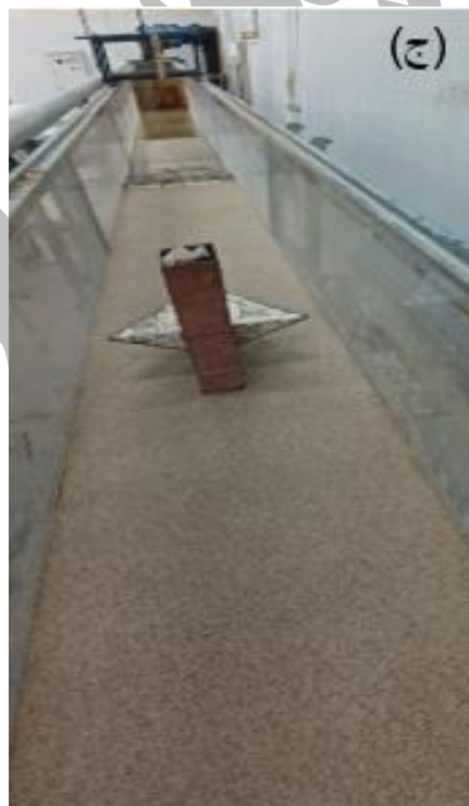
شکل ۱- الف، نمای کلی از فلوم آزمایشگاه و نحوه قرارگیری اجسام شناور در جلوی پایه ب، پلان فلوم آزمایشگاهی و ج، فلوم آزمایشگاهی
