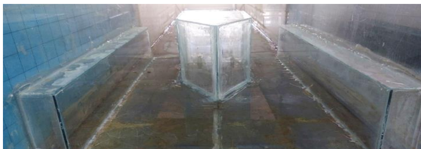
شکل ۴- مدل آزمایشگاهی ساخته شده شامل کانال مرکب مستطیلی با سازه بافل مرکزی
