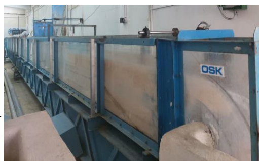
شکل ۱-نمایی از فلوم به همراه تجهیزات ورودی و خروجی جریان:
