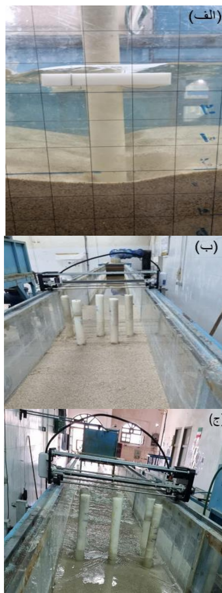
شکل ۳- نمایی از قرارگیری پایه‌ها، الف) گروه پایه ۳ تایی، ب) گروه پایه ۵ تایی و ج) گروه پایه ۶ تایی
