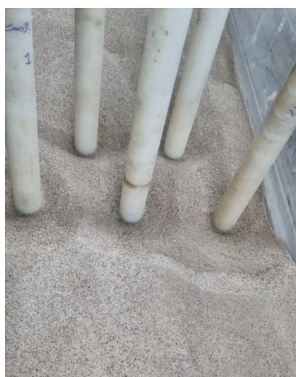
شکل ۷- نمونه‌ای از آبشستگی اطراف گروه پایه
