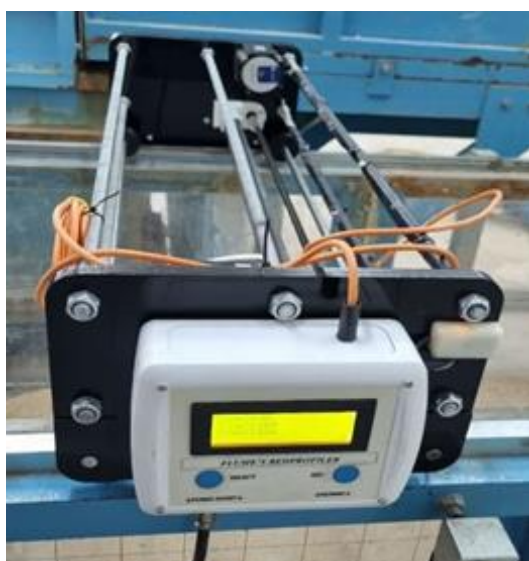
شکل ۵- دستگاه لیزری برداشت پروفیل بستر
