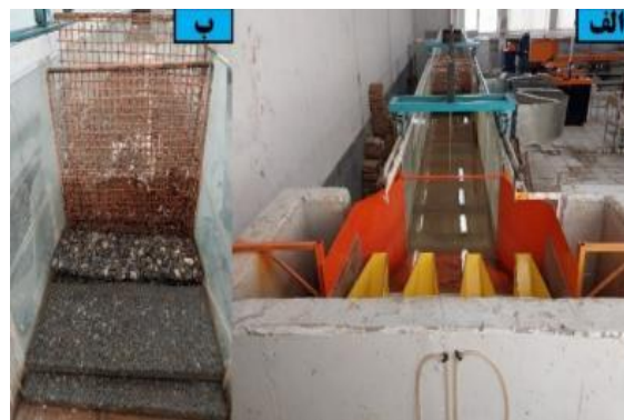
شکل ۱- تجهیزات آزمایشگاهی مورد استفاده (الف) نمای کلی کانال اصلی و محل نصب سرریز، (ب) شبکه‌های فلزی مشبک به‌منظور کاهش تلاطم و آرام‌سازی جریان
