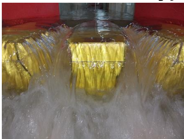
شکل ۸- آشفته‌گی زیر کلیدهای ورودی در سرریز کلید پیانویی مستطیلی با شیب ۵ درجه خلاف جهت جریان (دید از پایین‌دست)
