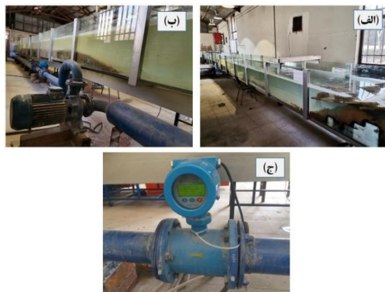
شکل ۲- نمایی از: (الف) کانال آزمایشگاه، (ب) پمپ و (ج) دبی سنج
