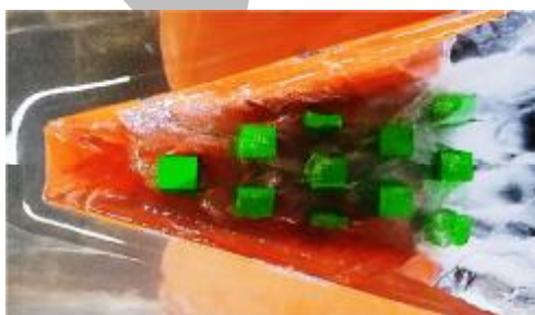
شکل ۳- نحوه قرارگیری بلوک‌ها در کلیدهای خروجی سرریز
