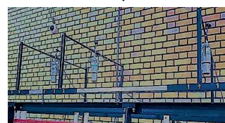
شکل ۲- (الف) کانال آزمایشگاهی، (ب) دستگاه PLC و (ج) سنسورهای آلتراسونیک
