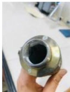
شکل ۱- لوله استیل ۳۰۴ لایه‌نشانی شده با نانوذرات TiO_2 با غلظت ۳۵ میلی‌گرم بر سانتی‌مترمربع
