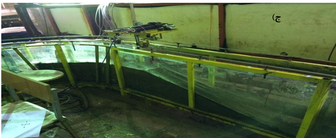
شکل ۴- سیفون نمونه‌گیری غلظت جریان غلیظ، (الف) موقعیت قرارگیری سیفون، (ب) ظرف نمونه‌برداری (ج) دستگاه سرعت‌سنج ADV
