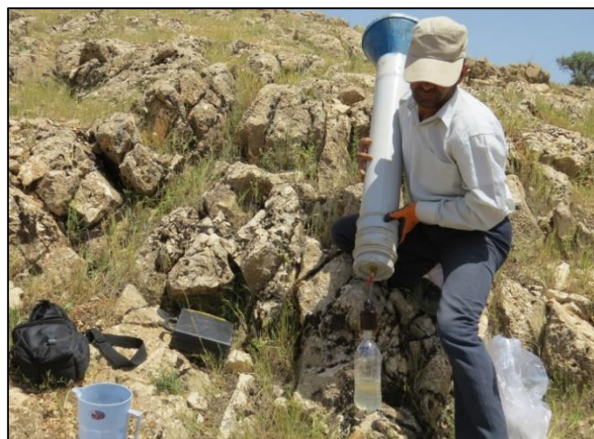
شکل ۲- نحوه برداشت نمونه‌های ایزوتوپی بارش
