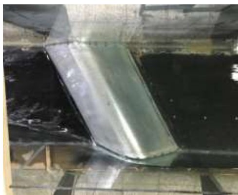
شکل ۴- نحوه استقرار سرریز مورب در کانال آزمایشگاهی (تصویر از بالا)
