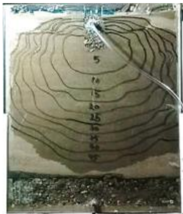
شکل ۲- ترسیم خطوط جبهه رطوبتی در بازه‌های زمانی ۵ دقیقه بر دیواره مدل فیزیکی
