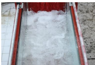
شکل ۳- تشکیل پرش هیدرولیکی در حوضچه از زوایای مختلف
