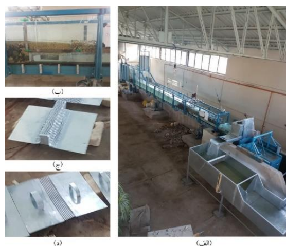
شکل ۲- (الف) نمای فلوم آزمایشگاهی، (ب) آبگیر متخلخل، (ج) سازه مشبک سه‌وجهی و (د) سازه مشبک یک‌وجهی
