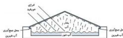
شکل ۱- نمایی از آبیاری تقطیری (آلیکو، ۲۰۱۷)
