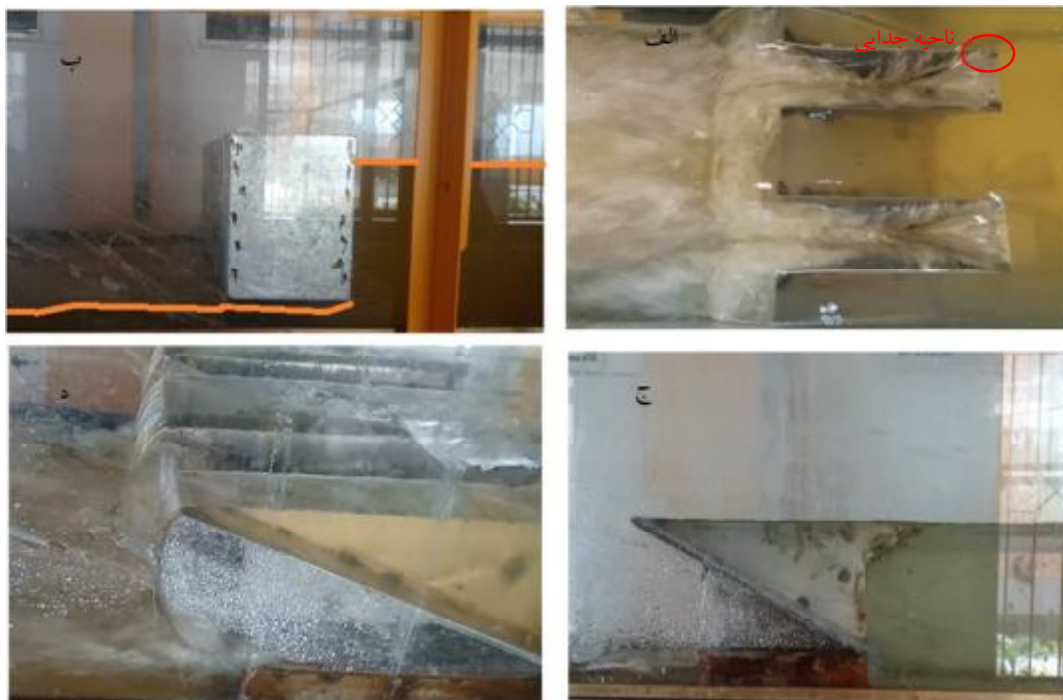
شکل ۳- نحوه عملکرد سازه الف) جریان عبوری سرریزهای کلیدپیانویی، ب) جریان عبوری از کالورت، ج) کارکرد کالورت در سازه ترکیبی، د) کارکرد کالورت و سرریز در سازه ترکیبی
