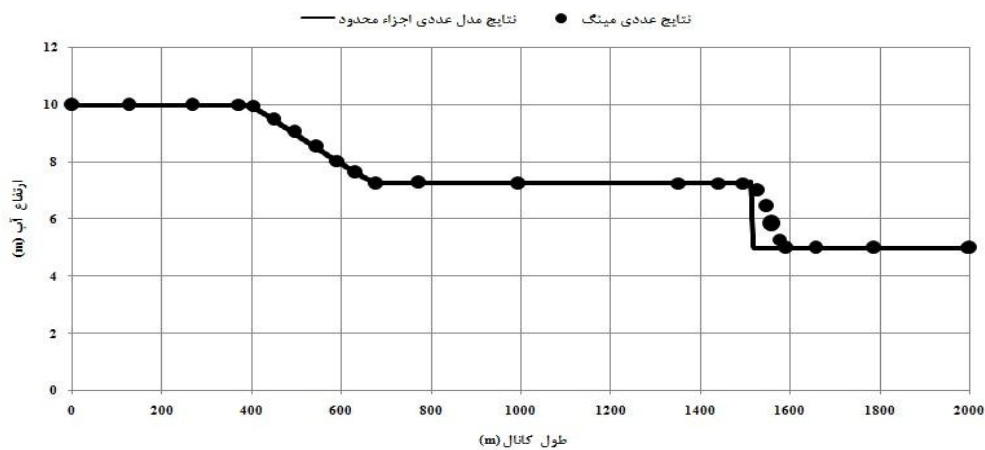
شکل ۲- مقایسه نتایج عددی و اجزاء محدود شکست سد با المان‌های سه گرهی، RMSE = ۷/۹۳\%
