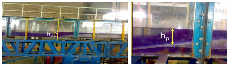
شکل ۳- ارتفاع غوطه‌وری مشاهده شده در آزمایشگاه
