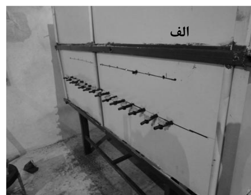
شکل ۱- الف) نحوه اتصال شیرها ب) نحوه قرارگرفتن لوله‌های زهکش در محیط متخلخل
