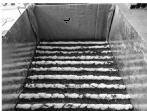
شکل ۱- الف) نحوه اتصال شیرها ب) نحوه قرارگرفتن لوله‌های زهکش در محیط متخلخل
