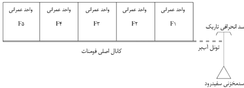
شکل ۱- آرایش شماتیک کانال اصلی فومنتات
