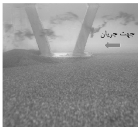
شکل 1- نمایی از فلوم آزمایشگاهی و گروه پایه پل کج نصب شده در ترازهای مختلف
