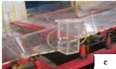
شکل ۲- نمایی از الف) مدل سرریز تنداب سد داریان، ب) سیستم هواده، ج) داکت هواده
