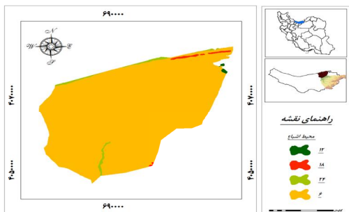
شکل ۶- نقشه پهنه‌بندی امتیاز محیط اشباع با مدل دراستیک
