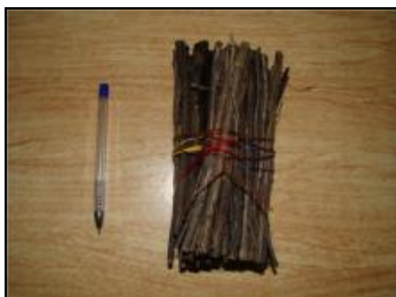
شکل ۵- تهیه نمونه ریشه برای انجام آزمایش کشش
