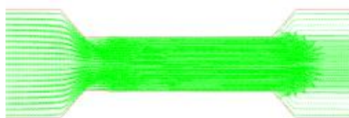
شکل ۱۵- شبیه‌سازی جریان‌های چرخشی در مدل تنگ‌شدگی تدریجی ۳۰ سانتی‌متر
