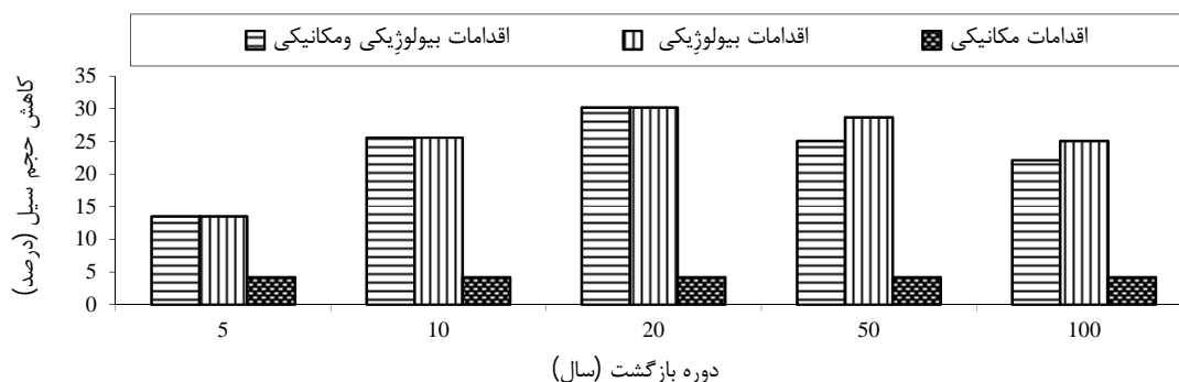
شکل ۶- کاهش حجم سیل بعد از انجام اقدامات آبخیزداری (بر حسب درصد) در دوره بازگشت‌های مختلف
