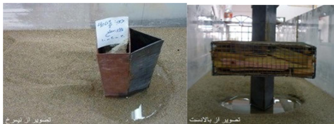
شکل ۵- نمایی از آبشستگی پس از زمان ۴۲۰ دقیقه با
