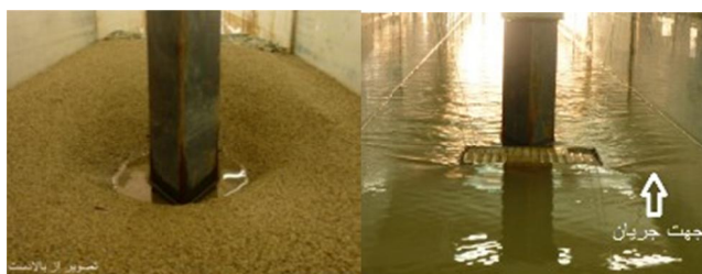
شکل ۶- نمایی از حداکثر عمق آبشستگی در زمان ۴۲۰ دقیقه با
