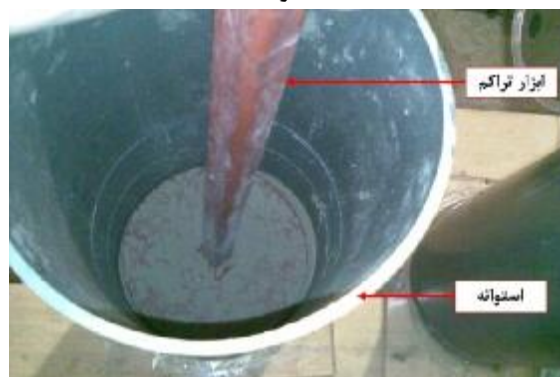
شکل ۳- ابزار مخصوص تراکم خاک در استوانه
