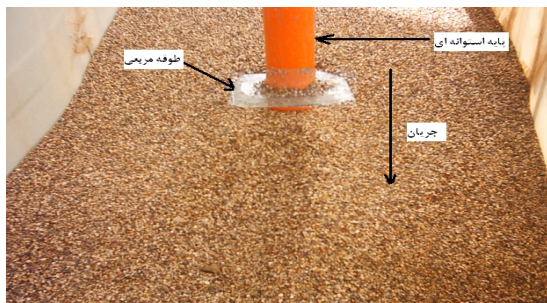
شکل ۶- محل تشکیل آب‌شستگی و رسوب گذاری در اطراف پایه با طوقه مربعی
