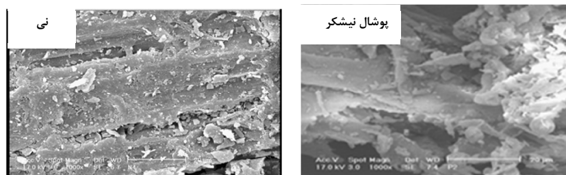
شکل ۱- تصاویر SEM از جاذب‌های نی و پوشال نیشکر
