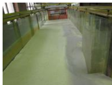
شکل ۱- نمایی از فلوم آزمایشگاهی مورد استفاده در آزمایش‌ها
