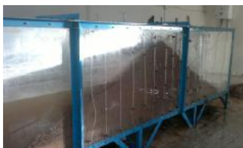
شکل ۱- مدل فیزیکی فلوم ساخته شده و پیژومترها
